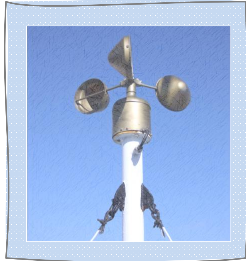
แอนีมอมิเตอร์ ใช้วัดความเร็วลม
